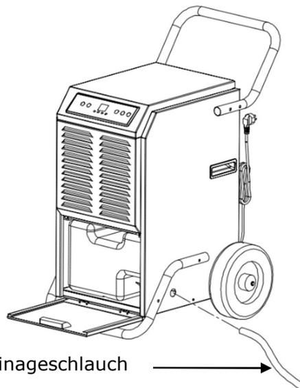
1. Entnehmen Sie den Wassertank und entleeren Sie diesen vollständig.
