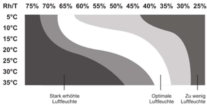
Das Diagramm geht davon aus, dass es sich bei Temperaturen  $\geq 20^{\circ}\text{C}$  um Wohnräume und bei Temperaturen  $\leq 20^{\circ}\text{C}$  um Kellerräume handelt.
