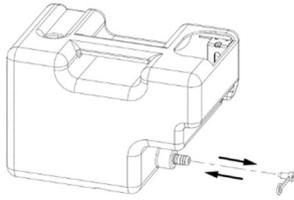
Achten Sie darauf, dass der Stöpsel des Wassertanks den Anschluss für den Schlauch sicher und fest verschließt.
