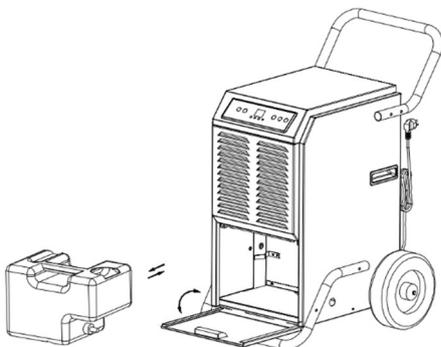
Der Wassertank befindet sich hinter einer Abdeckung an der Vorderseite des Gerätes. Öffnen Sie diese Abdeckung, um an den Tank zu gelangen.
